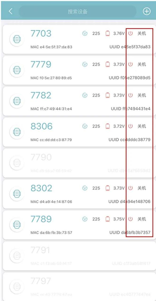
注意：只有被 INTELINK 扫描到的设备（高亮）能显示开关机状态。
