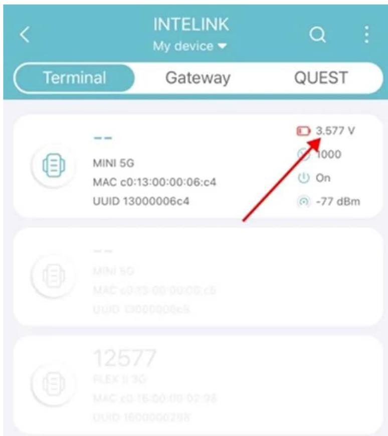
当电池充满时，电压会维持在 4.15 V。此时应拔出充电插头，并断开设备与充电器的连接。
